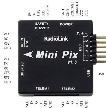
Figure 4. Flight Controller Mini Pix .v1.0
