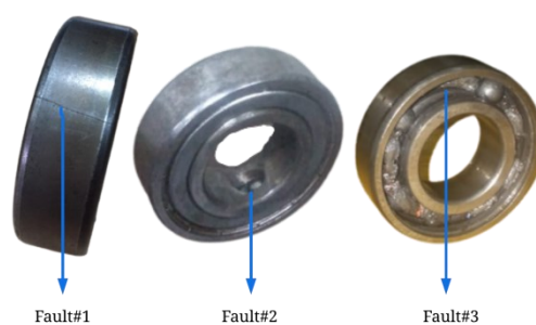
Figure 3. Bearing kondisi rusak sebagai pengujian
