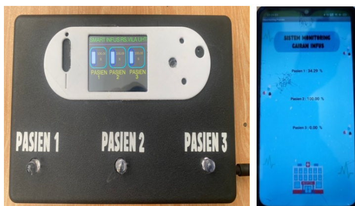
Figure 5. Hasil Perancangan Alat Monitoring Perawat dan Aplikasi
