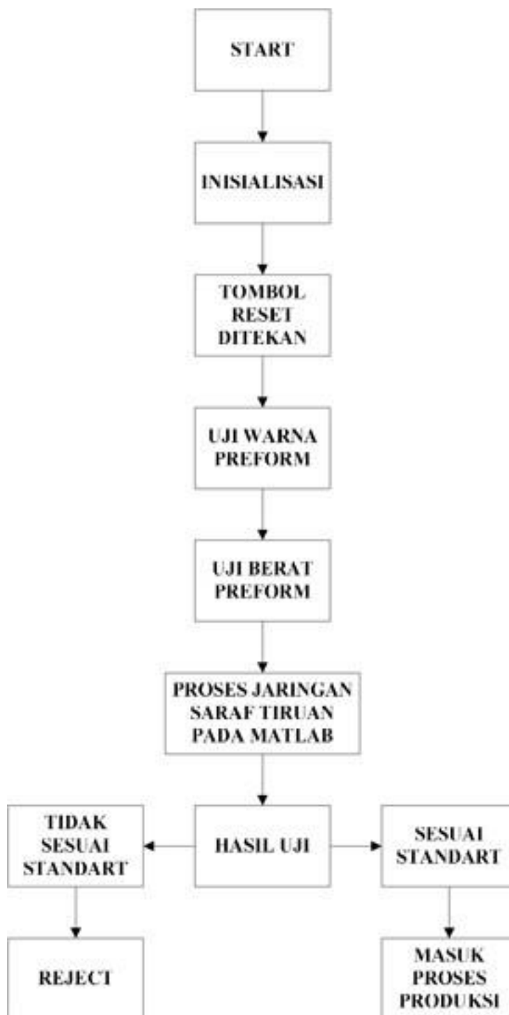
Gambar 2. Blok diagram cara kerja detektor standart preformbotol minuman
