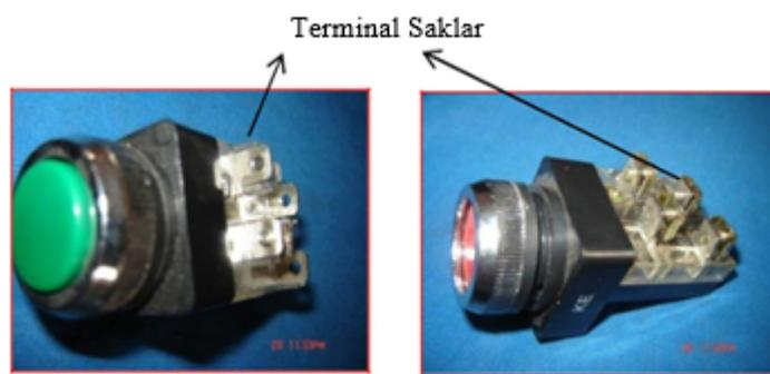
Gambar 14. Konstruksi saklar tombol (*Push Button*)
