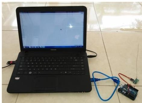
Gambar 7. Rangkaian Sistem Telemetri untuk receiver
