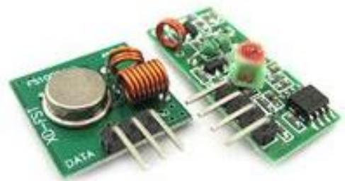
Gambar 4 : RF modul 433MHz MX-FS-03V & MX-05[4]
