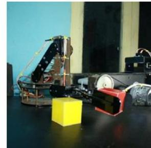
Gambar 9. Penempatan Objek Merah Oleh Robot Lengan
