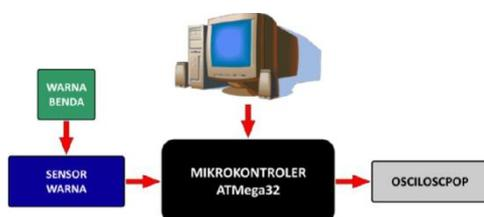
Gambar 6. Diagram Blok Pengujian Sensor Warna Dengan Warna Benda
